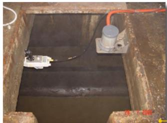
Mesure de niveau par Ultrasons avec courbe QH établie par Flo-Dar
