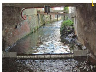
Sonde de niveau Ultrasons avec lame déversante
