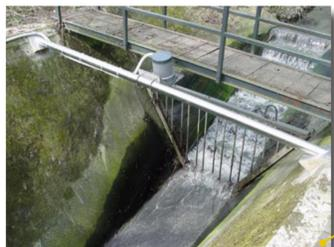
Sonde de niveau Ultrasons sur plan incliné
